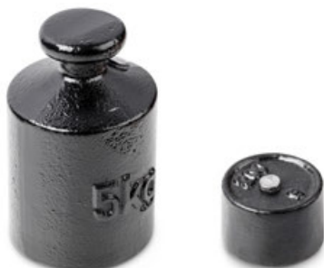
Poids individuels/jeux de poids, forme bouton et forme cylindrique, fonte laquée
